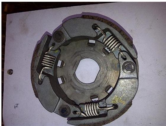
Gambar 2.9. *Clutch Carrier*
