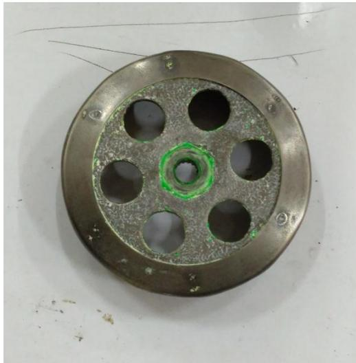
Gambar 2.10. *Clutch Housing*
