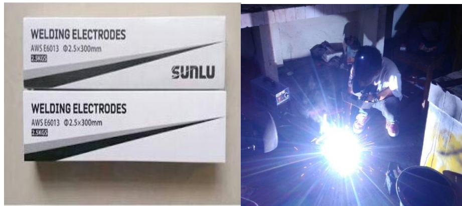
Gambar 4.4 Spesifikasi elektroda dan Proses Pengelasan
