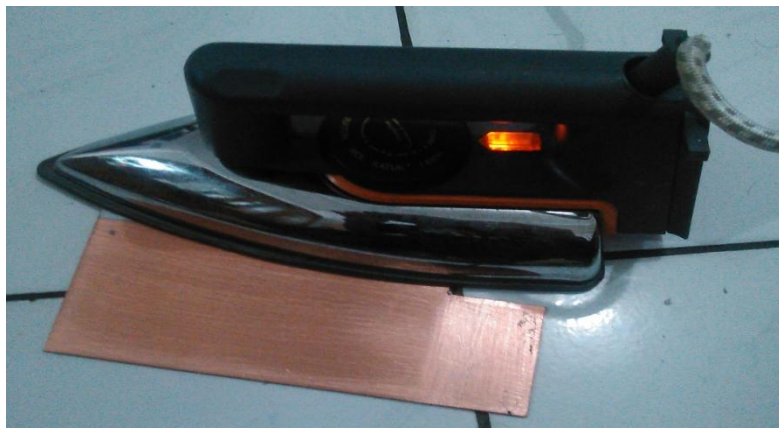
Proses Pencetakan dari Layout ke PCB
