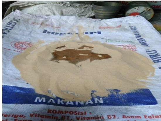
Gambar 4.4 pencampuran pasir silika dan water glass
