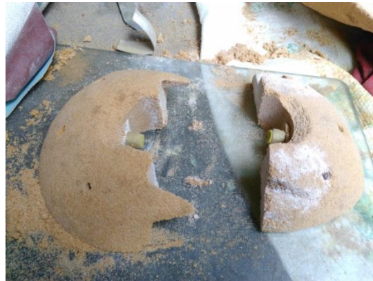
Gambar 4.13 Pelepasan piston pada pola
