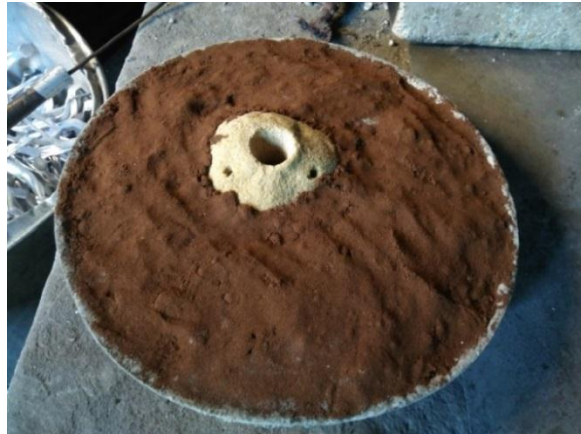
Gambar 4.19 Persiapan penuangan coran
