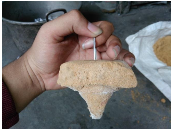
Gambar 4.17 Hasil cetakan pola bagian dalam piston
