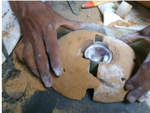
Gambar 4.14 Pemasangan piston melanjutkan pola
