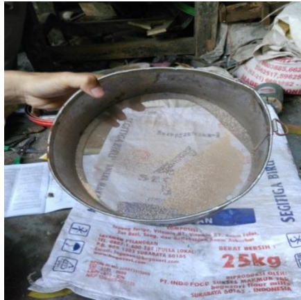
Gambar 4.1 Penyaringan pasir silika
