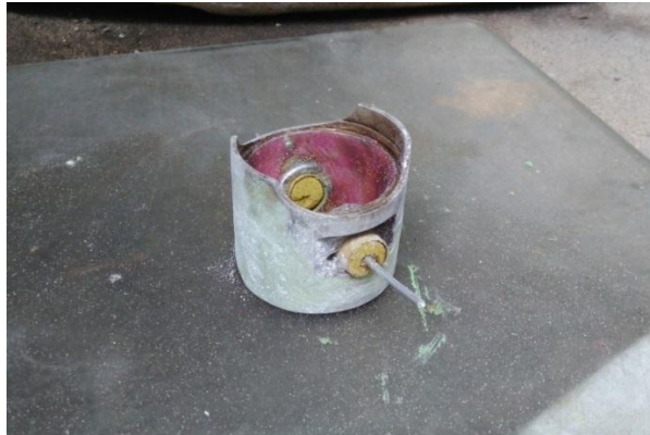
Gambar 4.8 Pemasangan pasir kuasa pada lubang piston
