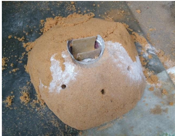
Gambar 4.12 Penguncian pasir kuasa
