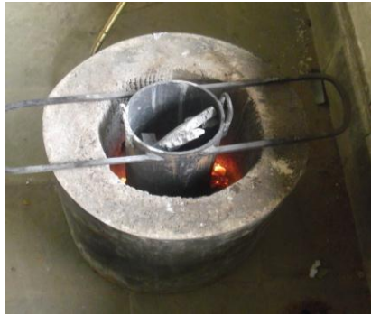
Gambar 4.23 Peleburan material Gambar 4.24 Cetakan siap tuang
