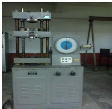
Gambar 2.2 Mesin Uji Tarik (*Tensile Test*).
