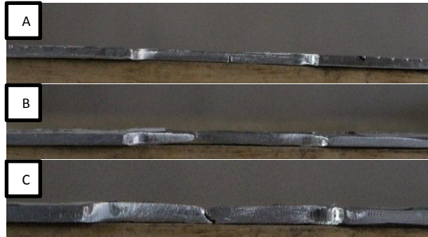
Gambar 15 Tampak samping patahan pada pengelasan putaran (a) tool 980 rpm, (b) tool 2300 rpm, dan (c) tool 2700 rpm,
