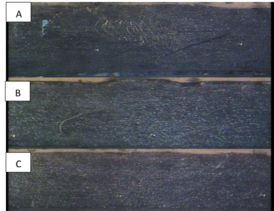
Gambar 6 (a) Struktur makro sambungan las FSW dengan variasi putaran tool 980 rpm, (b) 2300 rpm, dan (c) 2700 rpm.
