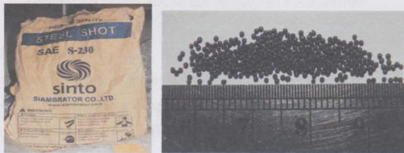
Gambar 3.3 Steel ball diameter 0,6 mm digunakan pada proses shot peening
