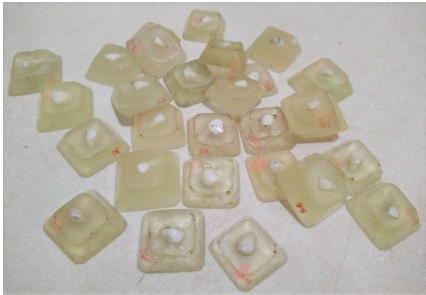
Sampel gigi desidui yang telah diberi resin dan siap untuk diuji
