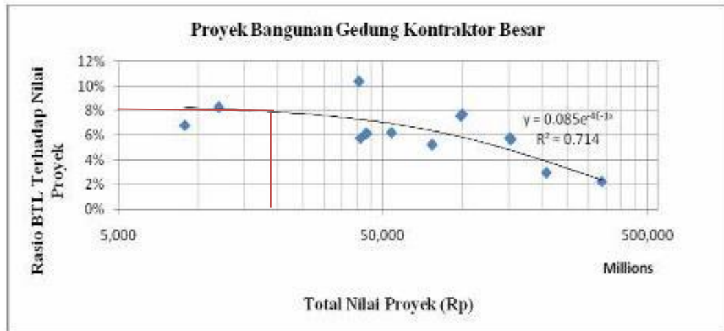
Gambar 5.1 Model hubungan biaya tidak langsung pada kontraktor besar.
