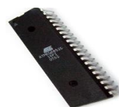
Gambar 2.5. bentuk fisik Atmega8535
