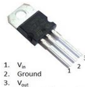
Gambar 2.13. Bentuk fisik IC 7805
