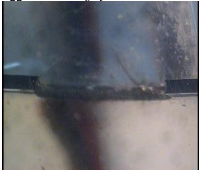
Gambar 12. Foto makro ketirusan pemesinan ECM material stainless steel 304 dengan gap 0,5 mm dan waktu pemesinan 371 detik
