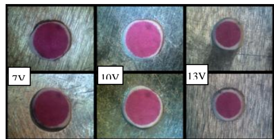
Gambar 7. Foto makro overcut aluminium 1100 dengan gap 0,5 mm dan waktu pemesinan 193 detik, bagian depan (gambar atas), bagian belakang (gambar bawah)
