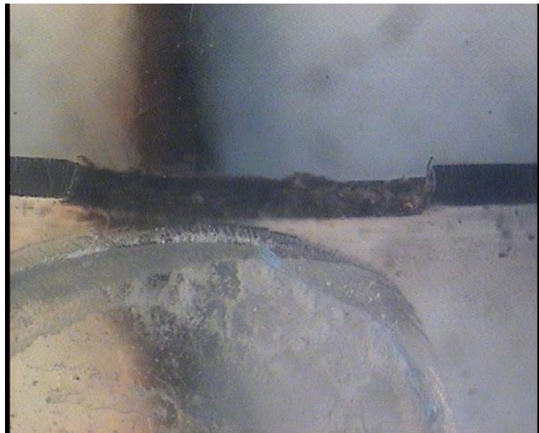
Lampiran 14. Foto makro ketirusan stainless steel 304 dengan gap 0,75 mm dan waktu pemesinan 371 detik
