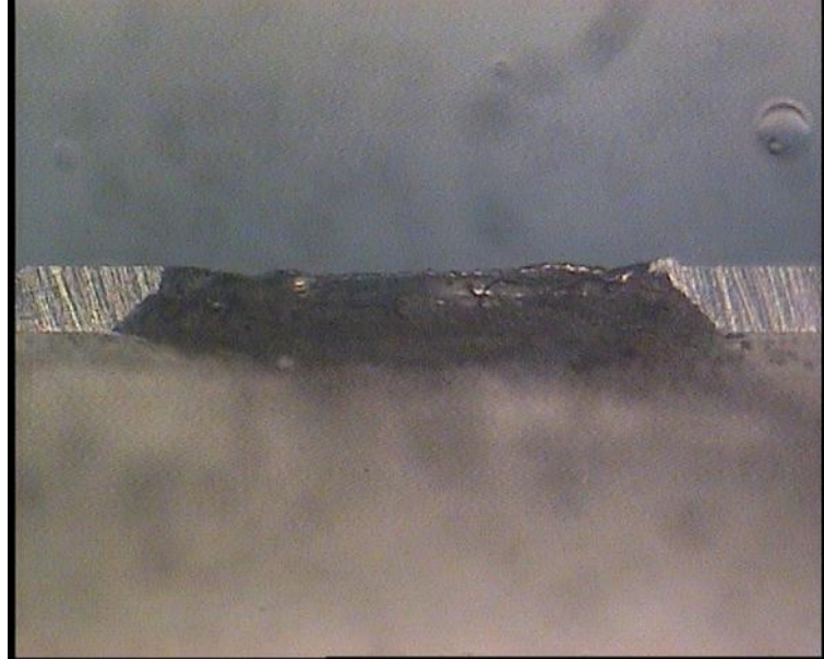
Lampiran 17. Foto makro ketirusan aluminium 1100 dengan gap 0,75 mm dan waktu pemesinan 193 detik
