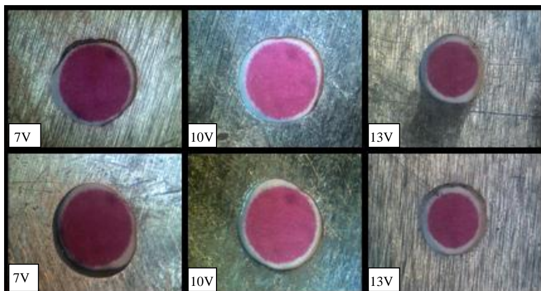
Lampiran 10. Foto makro overcut aluminium 1100 dengan gap 0,5 mm dan waktu pemesian 193 detik, bagian depan (gambar atas), bagian belakang (gambar bawah)
