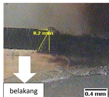
Gambar 4.17 Hasil ketirusan pemesinan ECM material stainless steel 304 dengan gap 0,75 mm dan waktu pemesinan 371 detik
