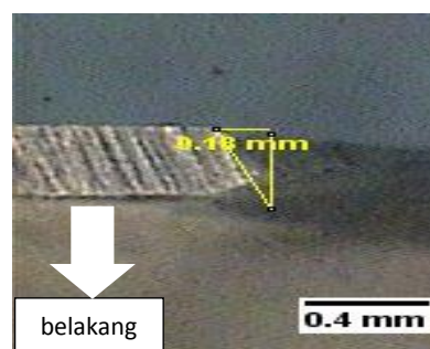
Gambar 4.21 Hasil ketirusan pemesinan ECM material aluminium 1100 dengan gap 1,0 mm dan waktu pemesinan 193 detik
