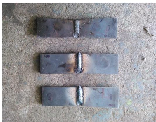
Gambar 4.4 Hasil pengelasan las listrik dengan variasi arus 80, 90 dan 100 A (ampere).
