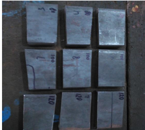
Gambar 4.2 Spesimen Baja Karbon Rendah SS 400
