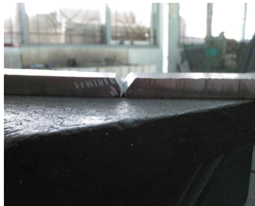
Gambar 4.3 Hasil pembuatan kampuh V untuk proses pengelasan
