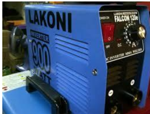
Gambar 3.3 Mesin Las Listrik tipe Falcon kapasitas maksimal 160 A.
