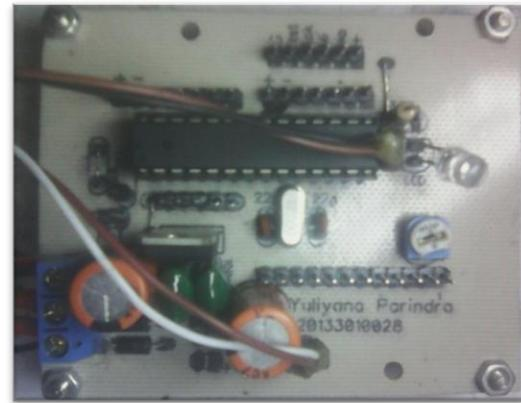
2. Rangkaian *Driver relay* dan sensor suhu yang telah dilarutkan dan di bor
