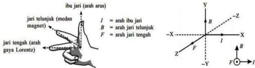
Gambar 2.10 Gaya pada kawat dalam medan magnet menggunakan kaidah tangan kanan[4]
