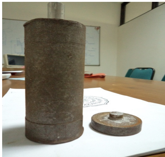
Gambar 0.7. Cetakan ( dies ) kompaksi serbuk
