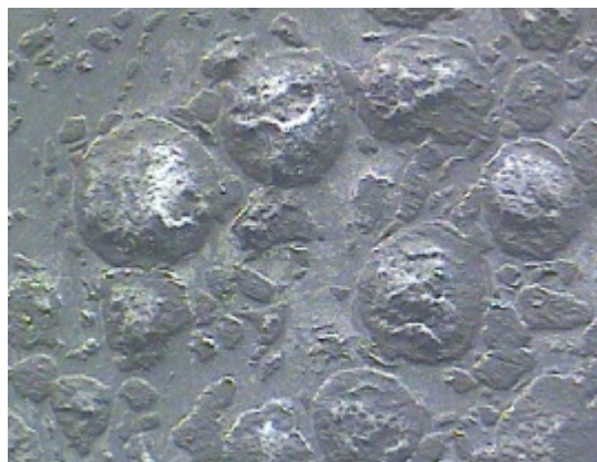
Gambar 0.4. Bentuk ruang-ruang kosong yang ditinggalkan oleh space holder urea (dengan mikroskope stereo perbesaran 19 x)
