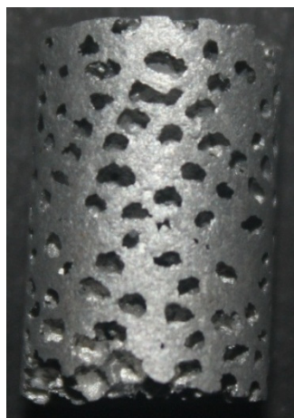
Gambar 0.5 Spesimen setelah proses sintering langsung diambil dari furnace dilihat dari samping dengan fraksi massa urea 70%.
