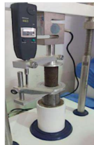
Gambar 3. Pengujian kuat tekan bebas di laboratorium
