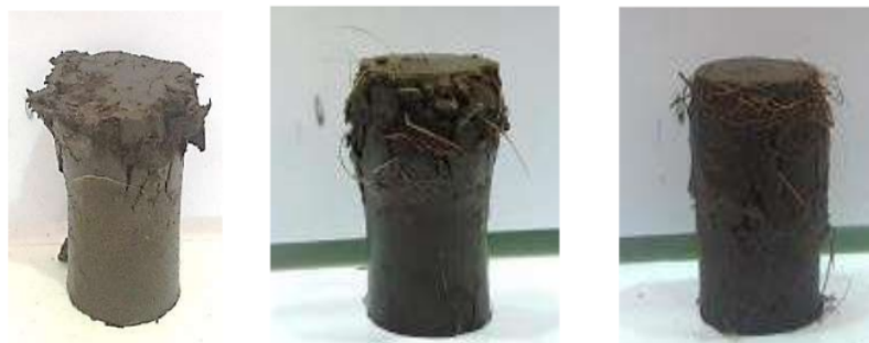
Gambar 4. Benda uji setelah pengujian dengan kadar serat (a) 0%; (b) 0,5%; dan (c) 1%
