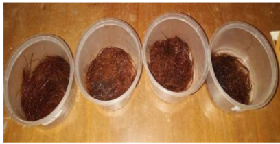
Gambar 7. Serat sabut kelapa yang drendam NaOH 30%
