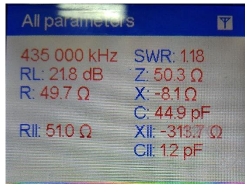
Gambar 10. Pengukuran semua parameter antenna sisi sebelah kanan
