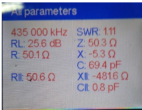
Gambar 9. Pengukuran semua parameter antenna sisi sebelah kiri
