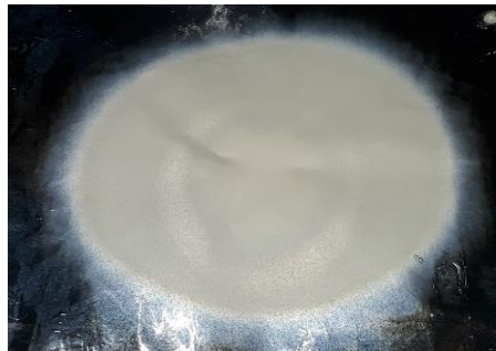
Gambar 3.11 Membran hasil fabrikasi menggunakan mesin electrospinning .
