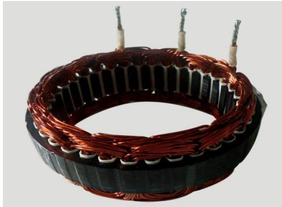
Gambar 2.2 Konstruksi stator (Sumber: Nisfi N.L.M, 2018)
