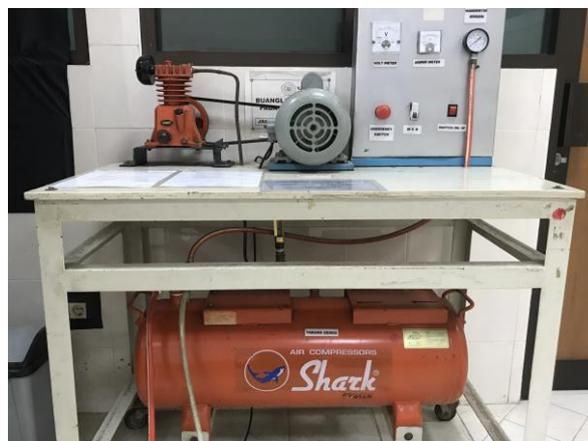
**Gambar 3.4** Kompresor udara
