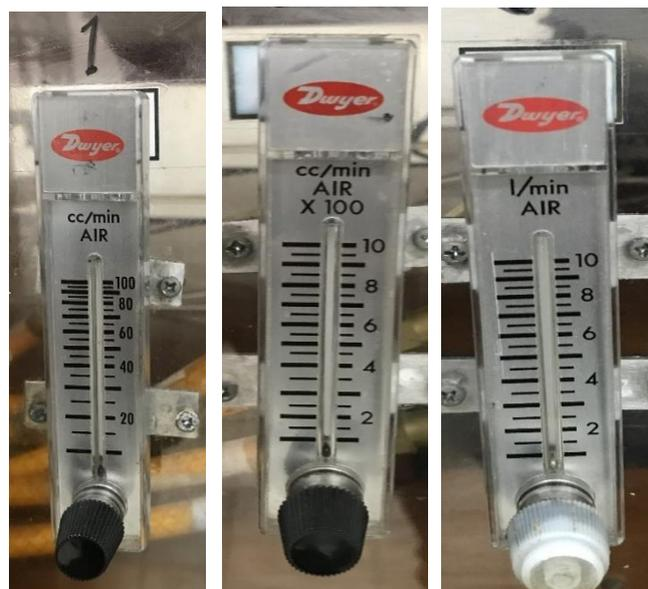
**Gambar 3.7** *Flowmeter* udara dengan kisaran debit maksimal 0 - 0,8 L/m, 0 - 3 L/m dan 0 - 10 L/m.
