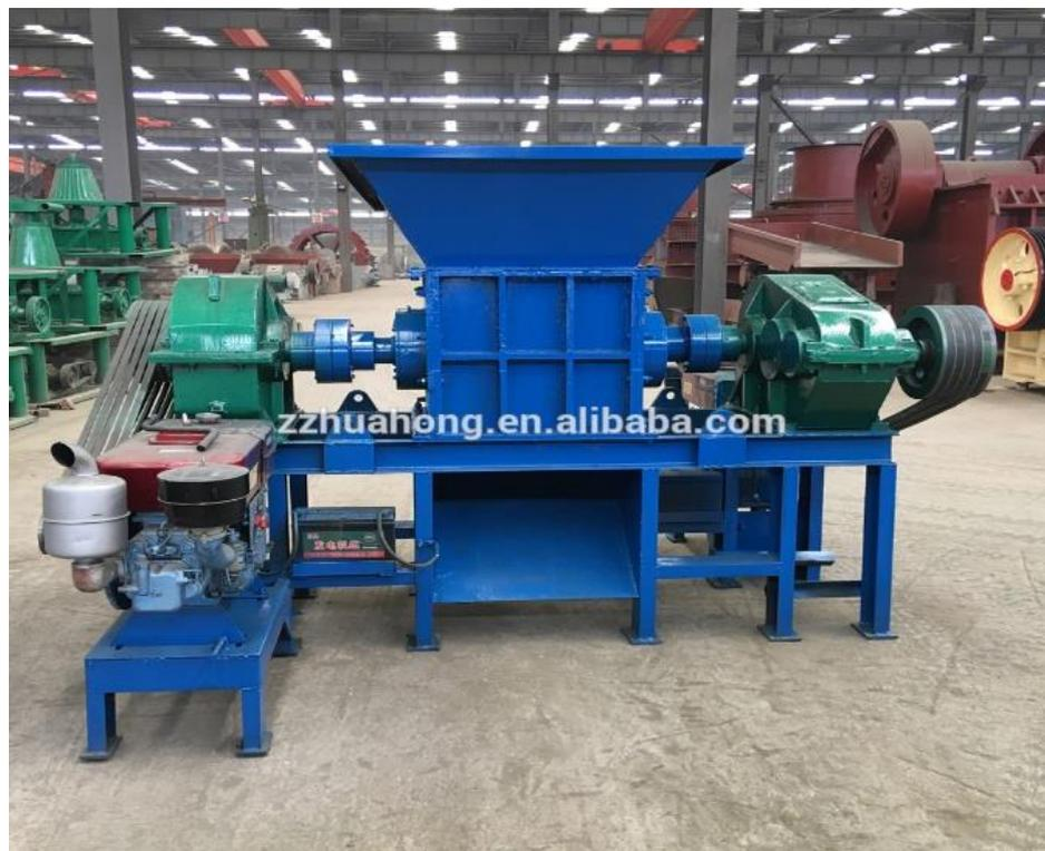
**Gambar 1.1** Mesin *Shredder* (zzhuahong.en.alibaba.com)
