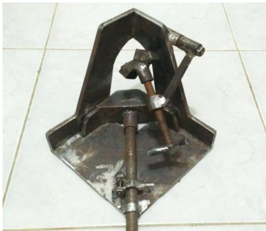
Gambar 4. 2. Three Axis Fixture Vise yang Telah Selesai Dibuat
