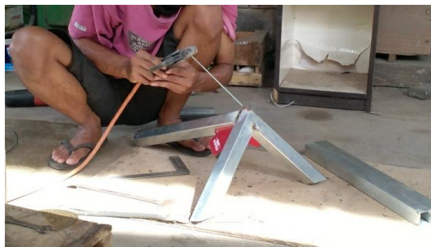
Gambar 4. 12. Proses Pengelasan Tanpa Menggunakan Three Axis Fixture Vise
