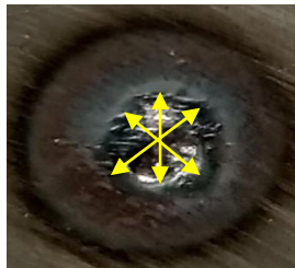
Gambar 2.5 Pengukuran diameter nugget hasil lasan spot welding pada permukaan stainless steel 430
