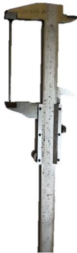
Gambar 3.3 Jangka sorong yang sudah di modifikasi
