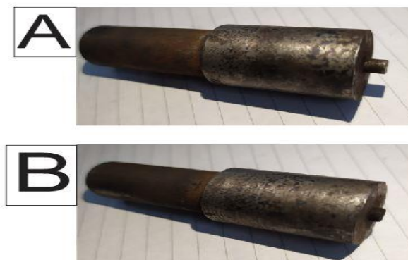
Gambar 2.3 Pin tool (A) Pin tool dengan panjang ujung 4mm dan (B) Pin tool dengan panjang ujung 2mm.
