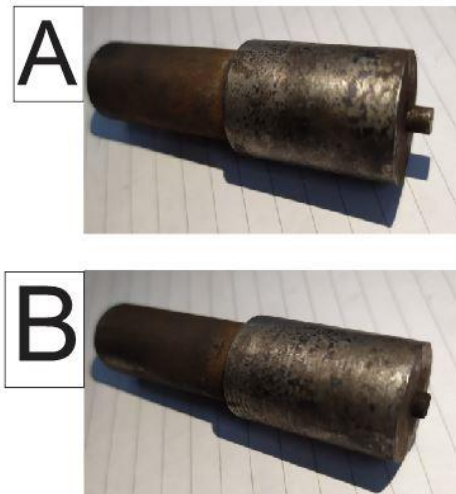
Gambar 3.9 Pin Tool yang sudah jadi dengan ujung diameter 4 mm dan pin tool yang sudah jadi dengan ujung diameter 2 mm
