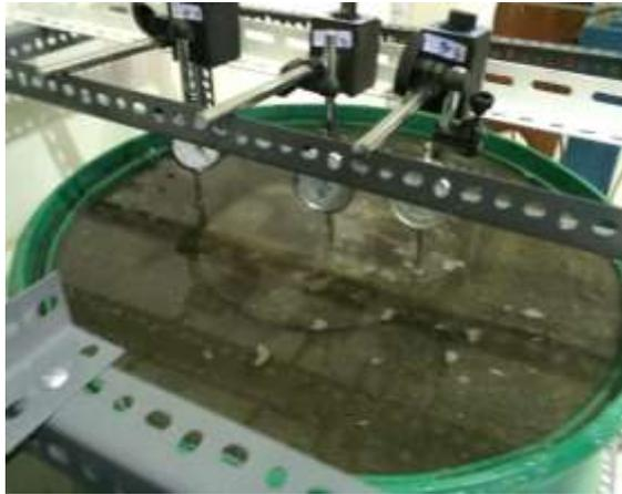
**Gambar 4. 9 Perendaman tanah dalam drum untuk uji pengembangan**
