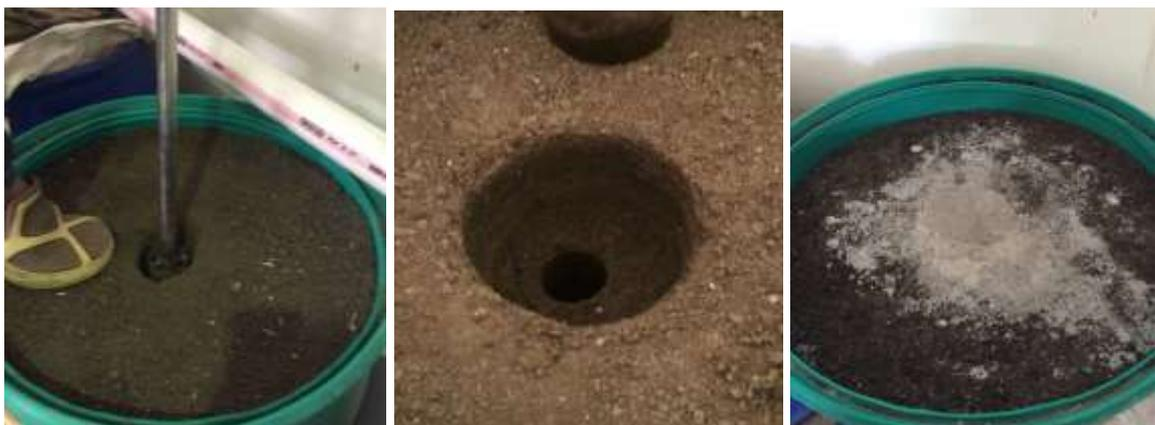
**Gambar 4. 8 (a) Pembuatan lubang (b) Pembesaran lubang, (c) Kolom SiCC.**
