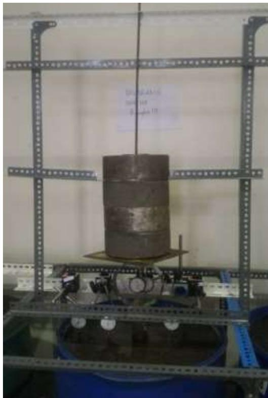
**Gambar 4. 7 Pengaturan uji beban langsung**
