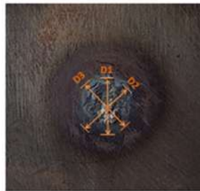
Gambar 4 Pengukuran diameter nugget hasil lasan spot welding pada permukaan stainless steel 430
