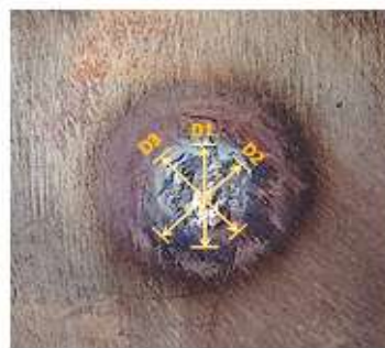
Gambar 4.2 Pengukuran diameter nugget hasil lasan spot welding pada permukaan stainless steel 430
