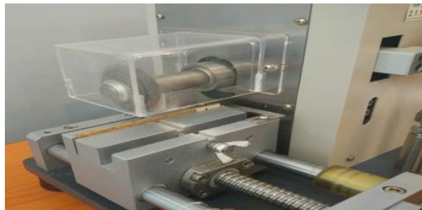
Gambar 3.19. Pemberian Takikan Pada Spesimen
