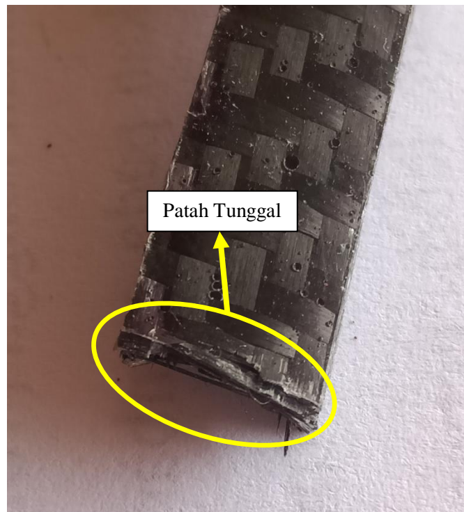
Gambar 4.18 Foto spesimen uji tarik variasi temperatur post curing 150°C.
