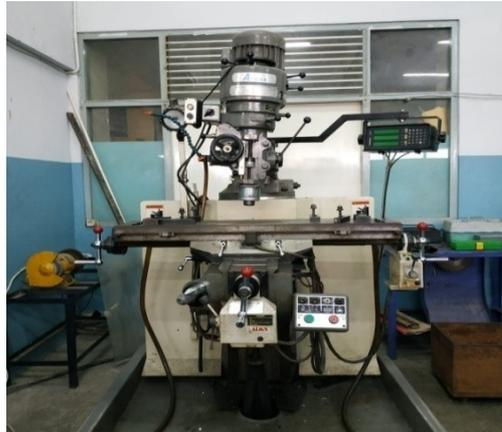
Gambar 3.2 Mesin Milling Vertikal
