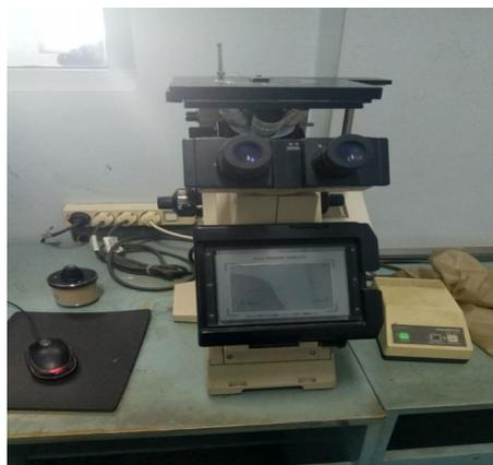
Gambar 3.5 Mesin Uji Strukur Mikro
