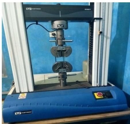
Gambar 3.3 Mesin Uji Tarik UTM
