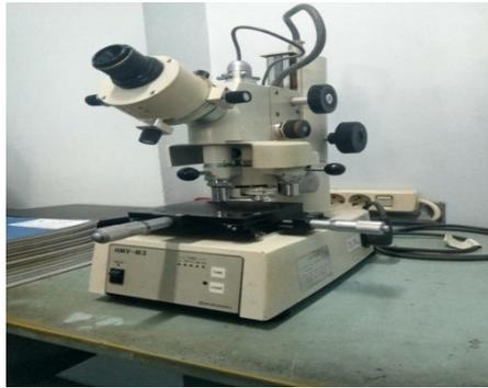
Gambar 3.4 Mesin Uji Kekerasan Vickers
