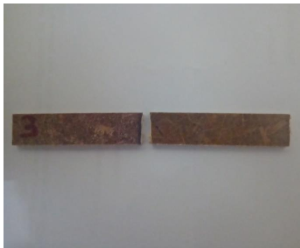
Gambar 4.7 Spesimen Hasil Pengujian Impak
