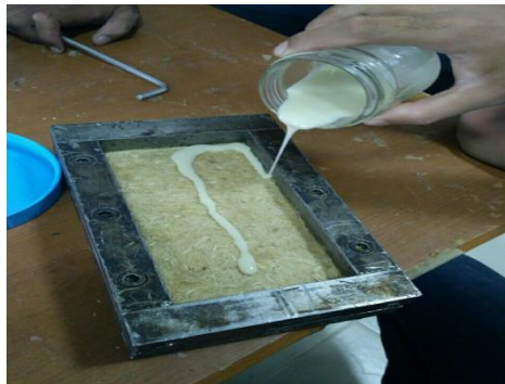
Gambar 3.29 Proses penuangan epoksi dan partikel yang sudah dicampur
