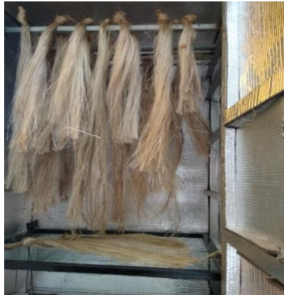
Gambar 3.22 Proses pengeringan serat kenaf
