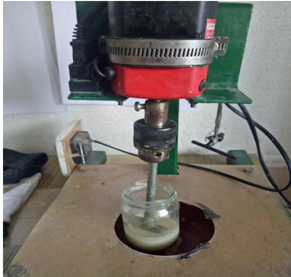
Gambar 3.28 Proses pencampuran epoxy dan jenis partikel
