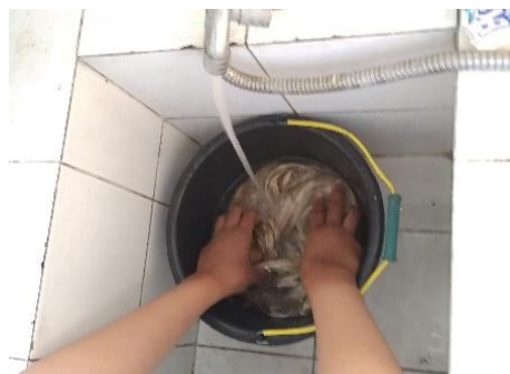
Gambar 3.21 Pencucian serat kenaf menggunakan air
