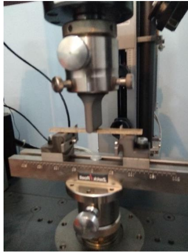
Gambar 3.34 Proses pemasangan pada span
