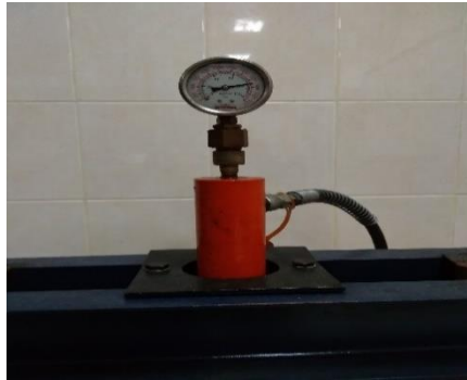
Gambar 3. 30 Proses press dengan mesin hot press
