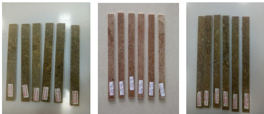
Gambar 3.33 Spesimen komposit hibrid yang sudah dipotong sesuai ukuran standar ASTM D790
