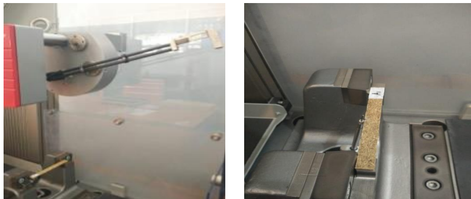
Gambar 3.37 Proses pengujian Impak
