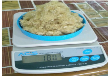
Gambar 3.26 Proses Penimbangan Serat Kenaf
