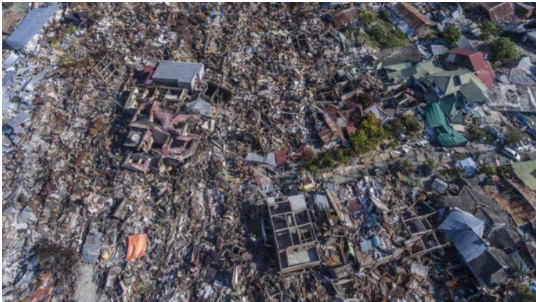
Gambar 1.3: Tanah di Perumahan Balaroa anjlok (terlikuifaksi) setelah gempa-tsunami melanda Kota Palu dan sekitarnya pada 28 September 2018. Sumber: https://www.bbc.com/indonesia/indonesia-45708229
