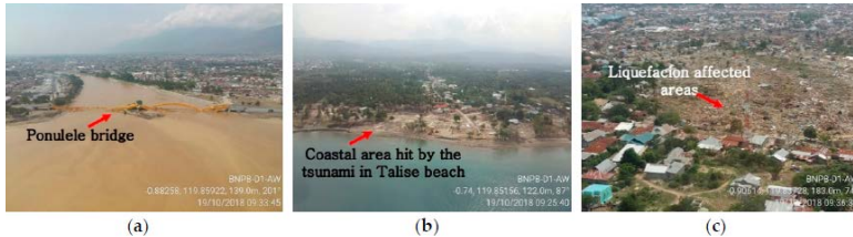
Gambar 1.1: Foto yang memperlihatkan kondisi pasca-gempa Palu 7,4 M_w –runtuh jembatan Ponulele (a), bencana tsunami yang menyapu kawasan pantai (b), dan bencana likuifaksi di Palu (c). Sumber: Syifa et al. (2019)
