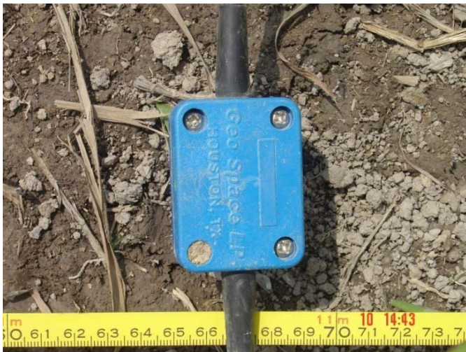
Gambar 3.1: Sensor geofon dengan frekuensi natural 28 Hz untuk mendeteksi perambatan gelombang permukaan
