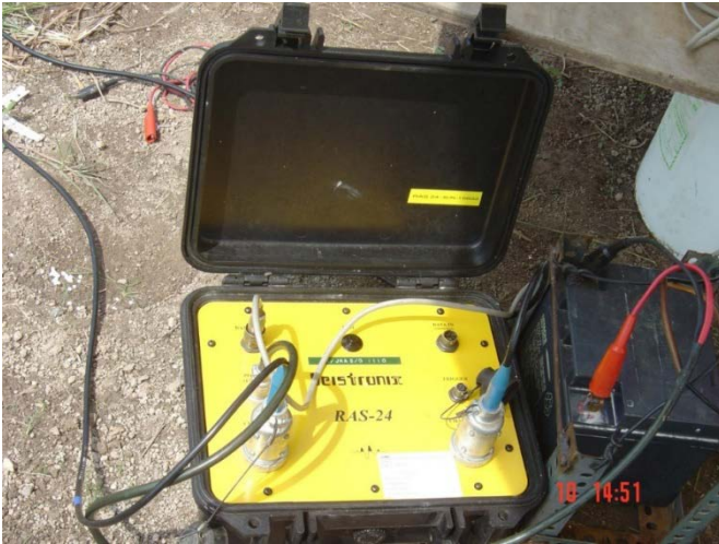
Gambar 3.2: Alat seismograf yang dihubungkan pada sensor geofon dan komputer untuk perekaman data gelombang permukaan
