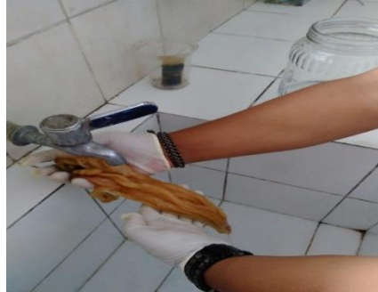
Gambar 3.12 Pencucian serat abaka dengan air mengalir
