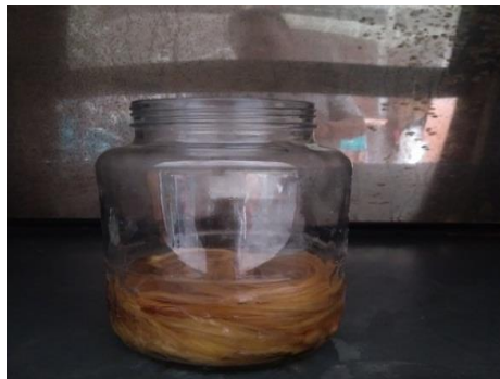
Gambar 3.13 Proses Netralisir NaOH pada serat
