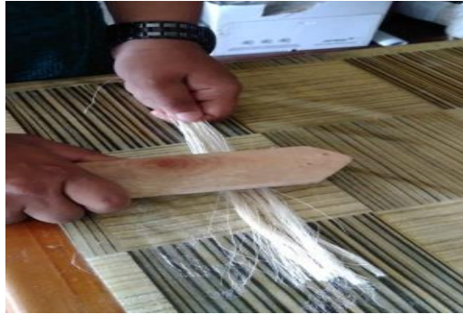
Gambar 3.15 Proses penyisiran serat
