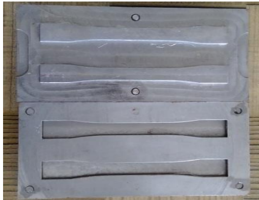
Gambar 3.2 Cetakan Pengujian Tarik ASTM D638-01
