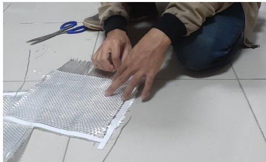
Gambar 3.18 Proses pemotongan serat gelas anyam
