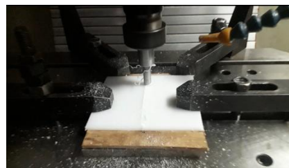
Gambar 2. Proses Pengelasan FSW dengan Mesin CNC
