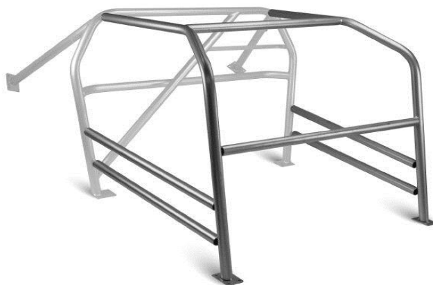
Gambar 3.1 Desain Rollbar 6 titik
