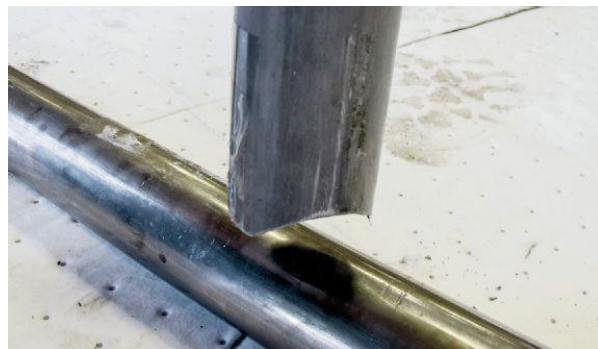
Gambar 3.13 potongan hub setengah lingkaran.
