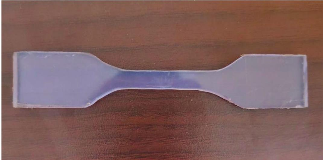
**Gambar 3.15** Spesimen Uji Tarik
