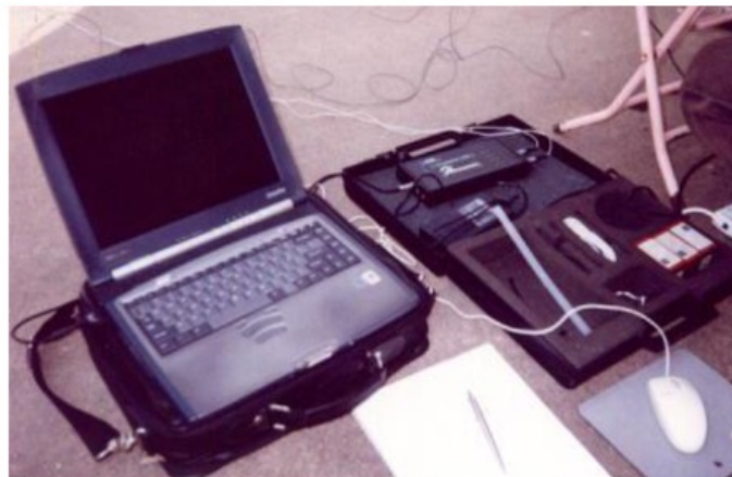
Gambar 3-3. Rangkaian komponen dalam system pengukuran teknik GSP: Komputer, ADT yang disambungkan ke alat sensor
