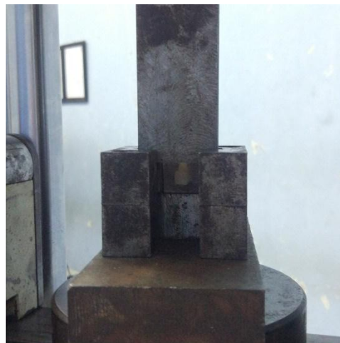
Gb 7. 1. Sampel gigi ditempatkan dalam penopang baja
