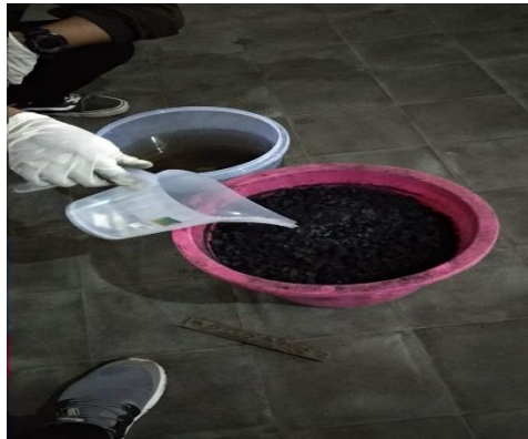
Gambar 3.14. Perendaman arang dengan aktivator
