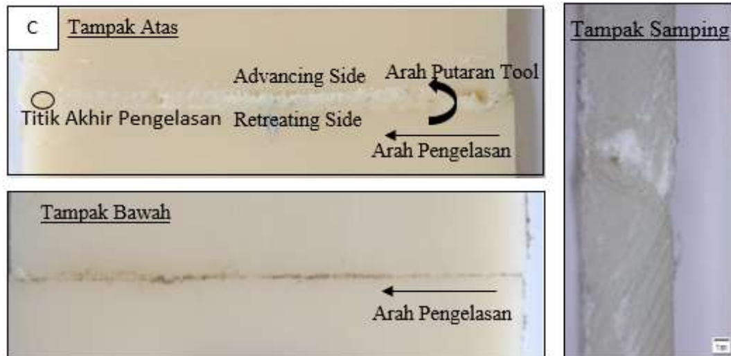
Gambar 5 Hasil pengelasan dengan metode FSW menggunakan parameter variasi bentuk pin tool a. Silinder, b. Silinder ulir, c. Tirus ulir dengan kecepatan putar spindle 2350 rpm dan feed rate 6 mm/menit.
