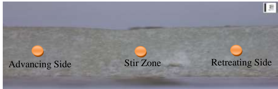
Gambar 7 Skema titik pada uji kekerasan
