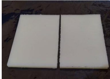
Gambar 3.9 Nylon 6 dengan dimensi 15 cm x 10 cm x 6 mm
