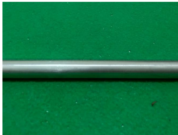
Gambar 3.8 Baja Pejal ST80 dengan diameter 15 mm
