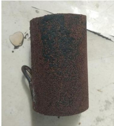
Gambar 3.13 Alat cetakan briket
