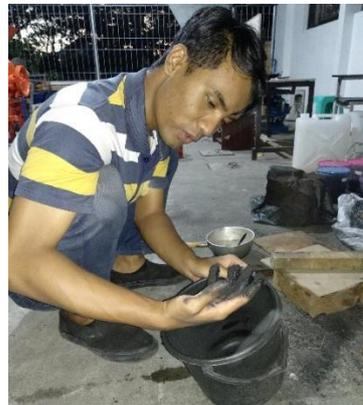
Gambar 3.28 Proses pencampuran serbuk batok kelapa dan kayu jati dengan perekat
